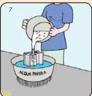
7. Inserire lo stampo in una bacinella di acqua fredda e colare il miscelato seguendo la linea dello stoppino.
